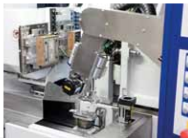
Ablegen, Montieren, Prüfen der Teile / Placing, assembly and inspection of parts
