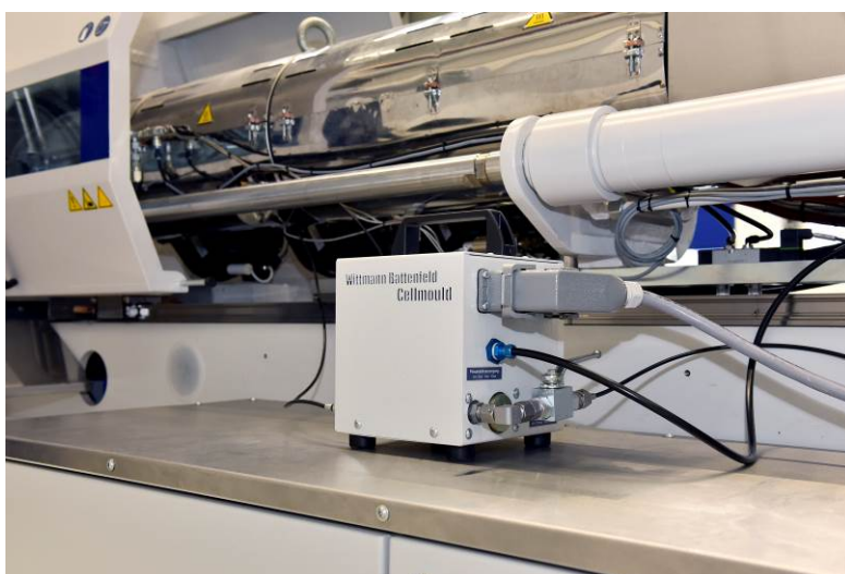
Fig. 3a: CELLMOULD® module on a MacroPower 1100
